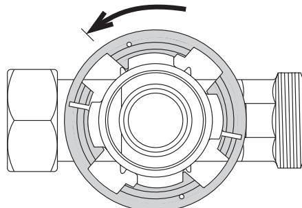
2. Introducir a presión las garras del aparato en las entalladuras y a continuación girar el aparato en 45° en el sentido de las agujas del reloj hasta el tope.
