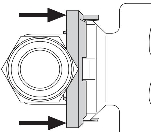
Zum Lösen des Dosiergerätes den Sicherungsring in Richtung Anschlussmodul drücken.
