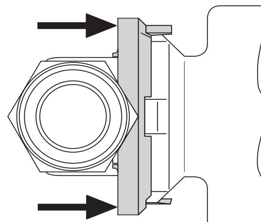
Per svitare il dosatore, girare l'anello di sicurezza in direzione del modulo di collegamento.
