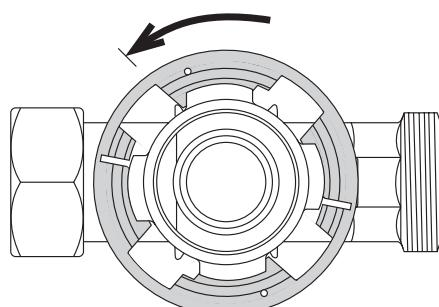
2. De klauwen van het apparaat in de uitsparingen drukken en het apparaat vervolgens met de wijzers van de klok mee 45° tot aan de aanslag draaien.
