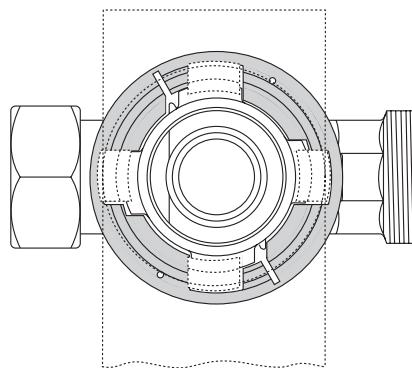
3. Den blauen Sicherungsring mit beiden Händen bis zum Einrasten in Richtung Gerät ziehen. Das Gerät ist nun gegen unbeabsichtigtes Verdrehen gesichert.
