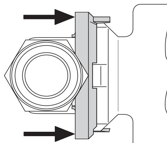
Duw om het doseerapparaat af te koppelen de borgring naar de aansluitmodule toe.
