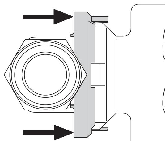
Para soltar el aparato de dosificación, empujar el anillo de seguridad en dirección al módulo de conexión.
