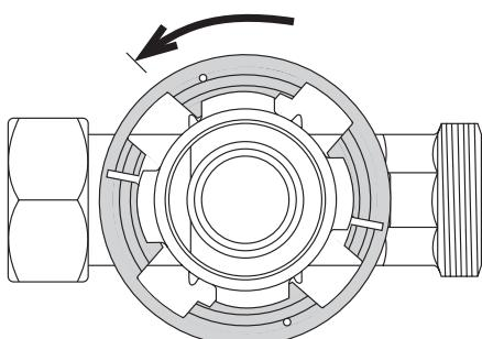
2. Klauen des Gerätes in die Aussparungen eindrücken und anschliessend das Gerät um 45° bis zum Anschlag im Uhrzeigersinn drehen.
