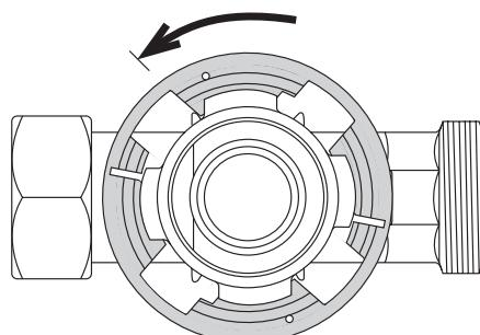
2. Enfoncez les griffes de l'appareil dans les encoches et tournez ensuite l'appareil de 45° en sens horaire jusqu'à la butée.
