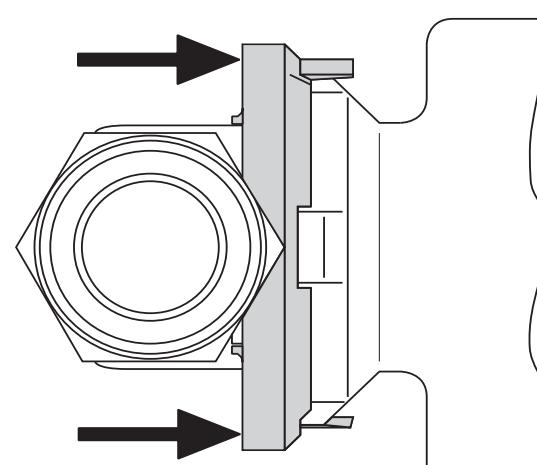
Pour desserrer l'appareil de dosage, appuyez sur l'anneau de sécurité vers le module de raccordement.
