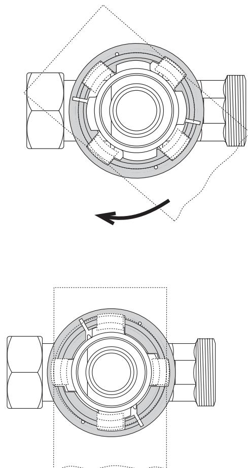
3. Tirez l'anneau de sécurité bleu des deux mains vers l'appareil jusqu'à l'enclenchement. L'appareil ne peut ainsi pas être tourné involontairement.
