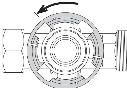
2. Premere i denti d'innesto dell'apparecchio nelle scanalature e ruotare l'apparecchio in senso orario di 45° fino all'arresto.
