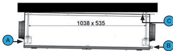
Montieren Sie das ComfoAir an einer Decke mit einer Masse von mindestens 200 kg/m<sup>2</sup>.
