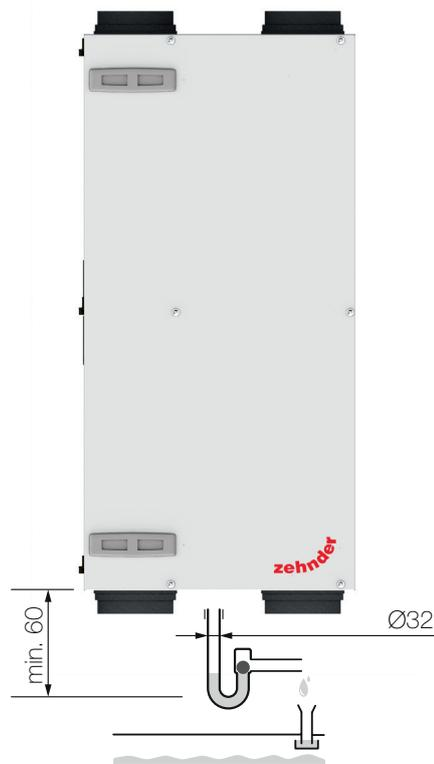
Im Wärmetauscher wird die warme Abluft durch die Außenluft abgekühlt. Dadurch kondensiert die Feuchtigkeit der Abluft im Wärmetauscher. Das sich im Wärmetauscher bildende Kondenswasser wird zum PVC-Kondensatablauf geleitet.
