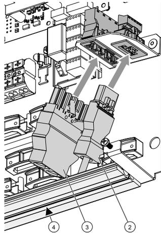
4. Steuerspannungs- und Fühlerkabel, Leitung für EVU-Sperre und Kabel externer Verbraucher vor Einbringen in den Wandregler abmanteln (Abisolierung der einzelnen Adern: jeweils 6 mm).
