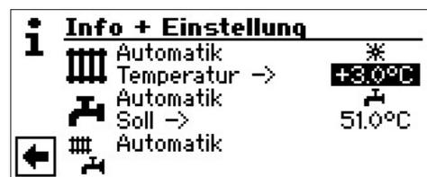
Eingabe durch Drücken des „Dreh-Druck-Knopfs“ beenden. Die gewünschte Temperatur wird dadurch gespeichert. Das Programm steuert automatisch das Symbol an.
