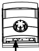
Die Funktion „Webserver“ ermöglicht, den Heizungs- und Wärmepumpenregler von einem Computer aus über einen Internetbrowser zu steuern.
