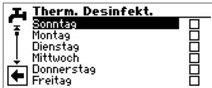
Tag(e), an dem (denen) eine thermische Desinfektion erfolgen soll, ansteuern und auswählen.
